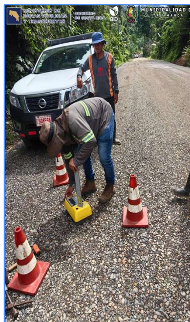
PRUEBA DE MEDICION DE COMPACTACION
