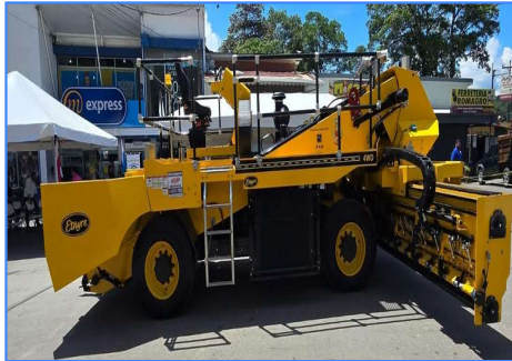
Multitribuidor de agregados (Áridos y asfalto).
